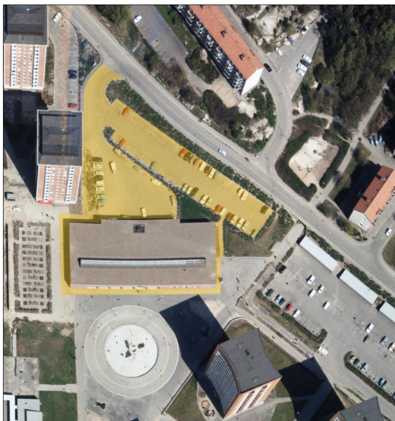
Figur 3. Flygbild över Rud 4:1 m.fl. från 1967 med utbredning av misstänkt tjärasfalt mar-kerat i gult.
